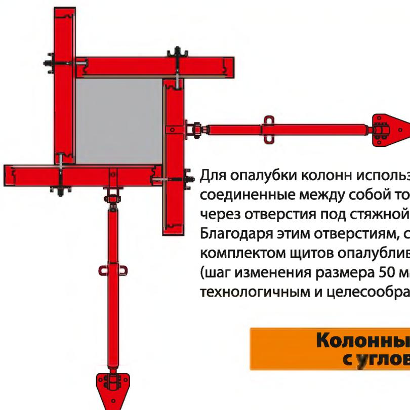
Для опалубки колонн используются универсальные щиты, соединенные между собой торцевыми болтами, пропущенными через отверстия под стяжной винт и отверстия в ребрах щита. Благодаря этим отверстиям, существует возможность одним и тем же комплектом щитов опалубливать колонны различного сечения. (шаг изменения размера 50 мм) Данный способ является наиболее технологичным и целесообразным.
