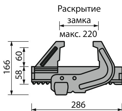
служит для соединения опалубочных щитов, их выравнивания и обеспечения жесткости конструкции. Литье, оцинковка.
