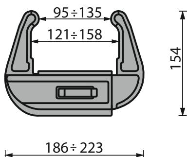
служит для соединения опалубочных щитов, их выравнивания и обеспечения жесткости конструкции. Ковка, оцинковка.
